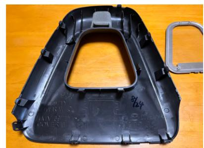
**最後にベゼルブロッカー周辺にも爪がありますので、ベゼル全体を押さえて爪の箇所が密着していることを確認し作業完了です。密着不足はカタカタ音の原因になりますのでお忘れなく！**
