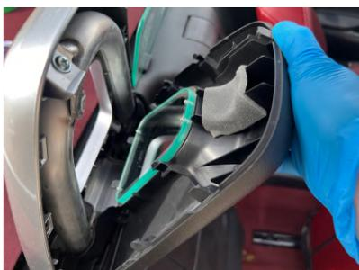
⇒ベゼルが外れたら、ベゼルブロッカーをお好みの向き見えるようにセットして、ベゼルの元に戻したら、ナットを摘んで左右の位置を微調整して下さい。
